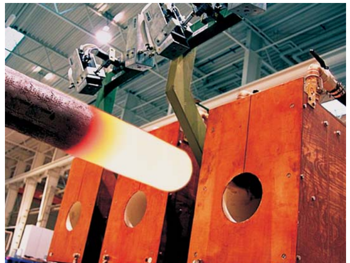
Bild 1: Temperaturerfassung des induktiv beheizten Materials
