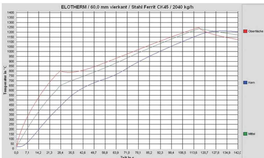
Bild 3: Aufheizzeit ca. 117s – Oberflächentemperatur 1250 °C
