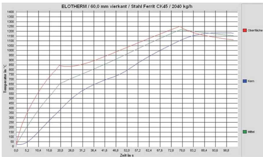
Bild 2: Aufheizzeit ca. 77s – Oberflächentemperatur 1250 °C
