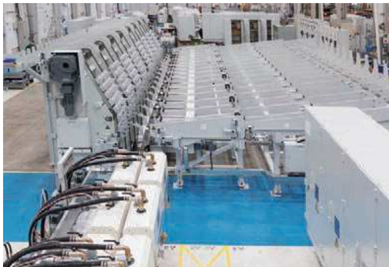
图 5 容量为 30 吨的棒料库，包含已加热料存储
